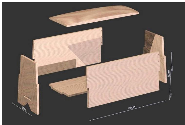
Abbildung 49: Schematischer Aufbau einer Sechsbrett-Truhe, Bild aus Web unbekannter Herkunft
