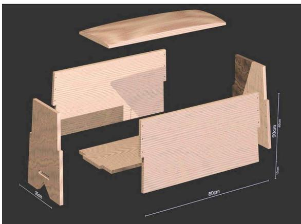
Abbildung 49: Schematischer Aufbau einer Sechsbrett-Truhe
